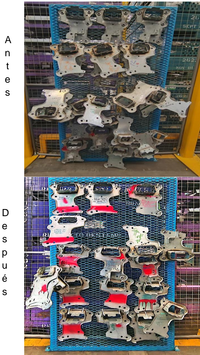
Ilustración 5. 6 Tablero de defectología en celdas shot plate. Fuente: Gestamp2023
