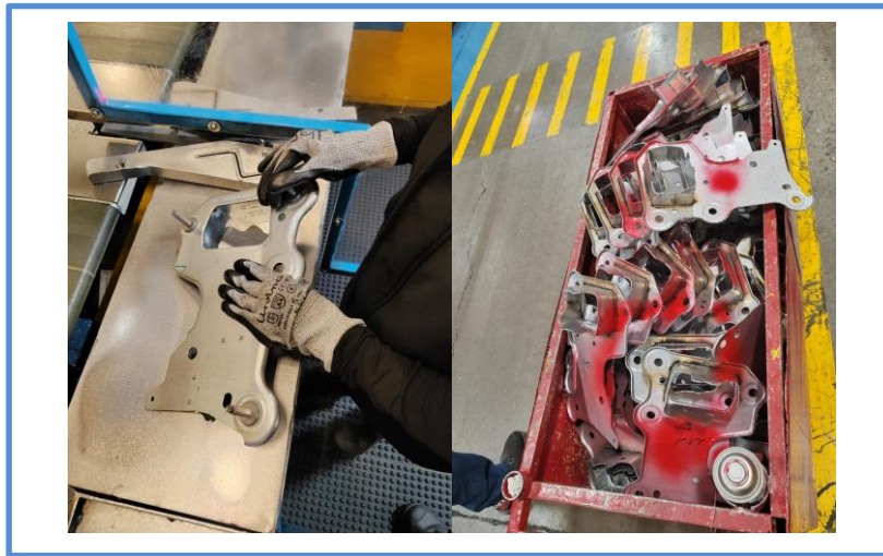
Ilustración 3. 1 . Forma de inspección y carro de producto con defecto. Fuente: Gestamp 2023
